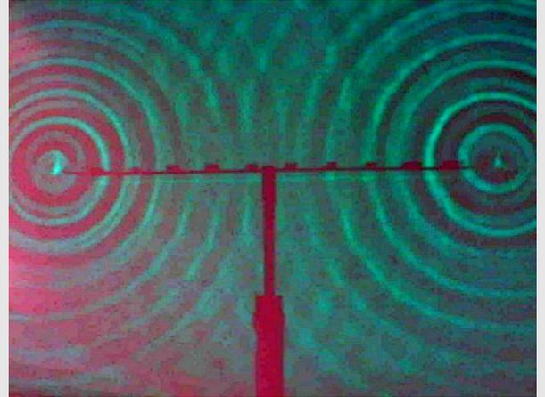
Typisches Wellenbild bei einer Erregerfrequenz von 25 Hz
