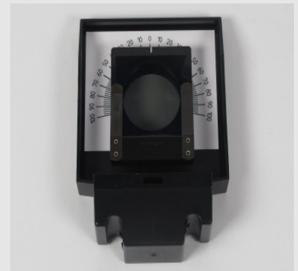
Polarisationsfilter im Blendenhalter auf Skale angebracht
