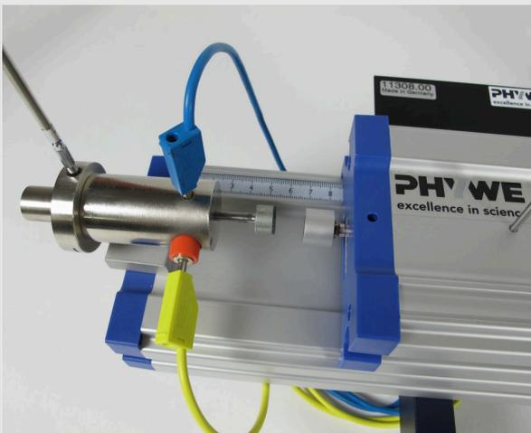
Dispositivo de lanzamiento del choque
