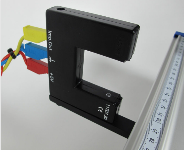
Установка световых барьеров
