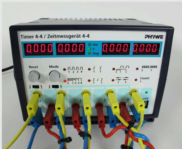
Подключение световых барьеров и пускового устройства
