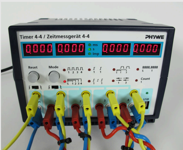
Conexión de las barreras de luz
