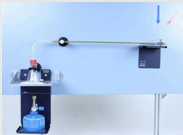
5. Lass das Rohr ein wenig abkühlen und baue es mithilfe eines Lappens aus.
