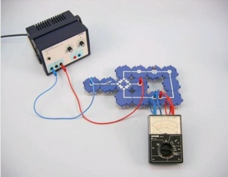
Verbindungsleitung am Netzgerät wie in der Abbildung dargestellt vom Gleichspannungsanschluss auf den Anschluss für 12 V~ umstecken.
