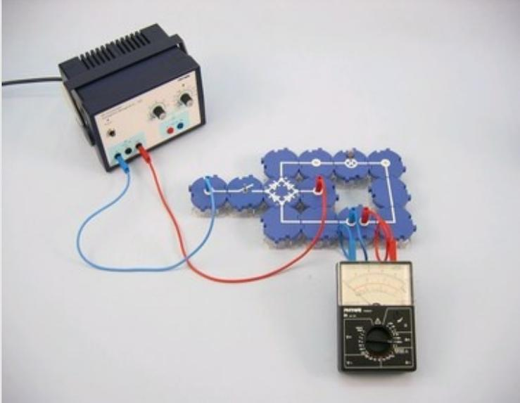
Conectar el cable de conexión en la fuente de alimentación como se muestra en la ilustración desde la conexión de tensión continua hasta la conexión para 12 V~.
