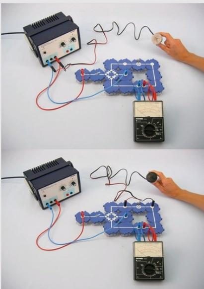
Conectar primero los auriculares directamente a la conexión para 12 V~ (fig. arriba) y luego en paralelo a la bombilla (fig. abajo).
