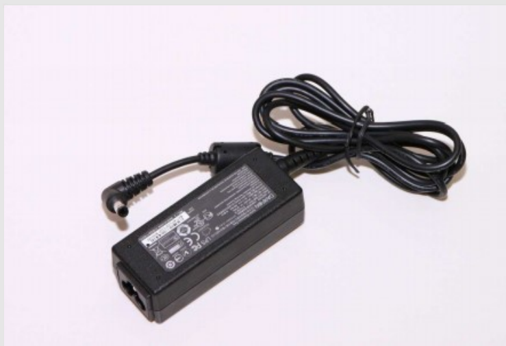
Блок живлення - приклад застосування випрямляча
