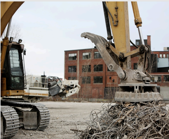
Electroimán en una excavadora para levantar chatarra
