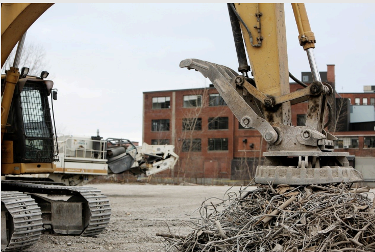
Electroimán en una excavadora
