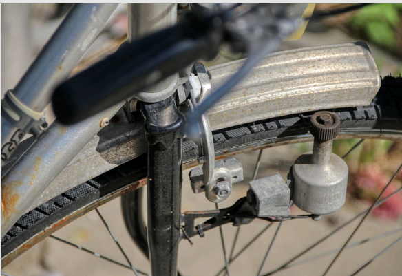
El dinamo de bicicleta como ejemplo de alternador
