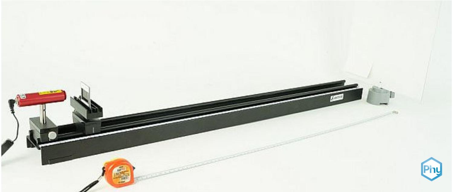
Si la luz monocromática incide en una rendija estrecha, detrás de ella aparecen mínimos y máximos de intensidad en una pantalla, a partir de cuyas posiciones se puede determinar la anchura de la rendija con una longitud de onda conocida.
