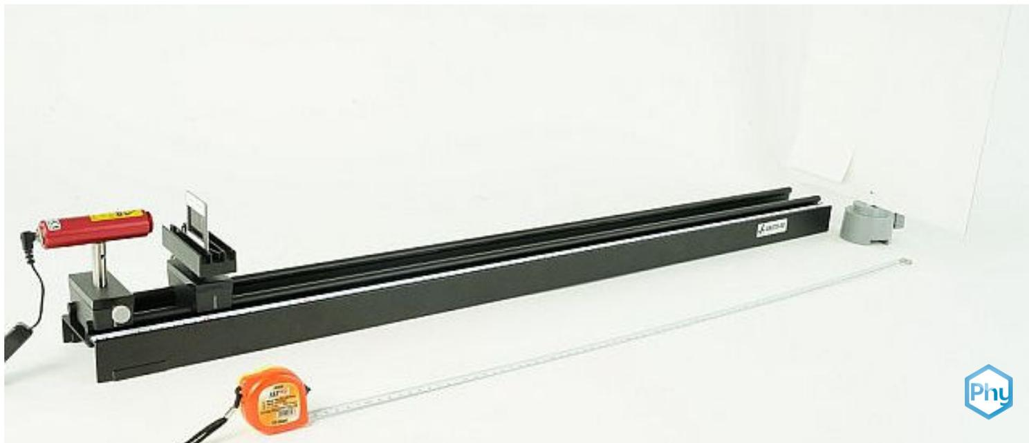
Если монохроматический свет попадает на узкую щель, за ней на экране появляются минимумы и максимумы интенсивности, по положению которых можно определить ширину щели при известной длине волны.
