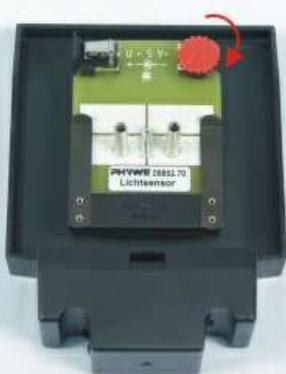
Rotation de l'amplificateur de la photodiode
