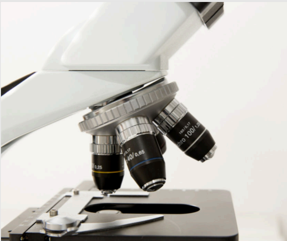
Objektive eines Mikroskops mit verschiedenen Vergrößerungen
