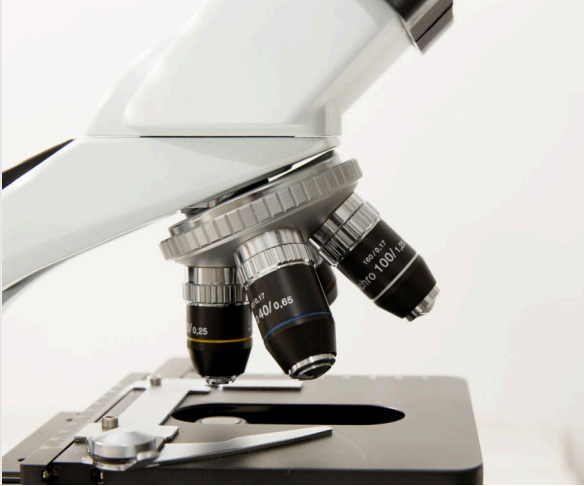
Objektive eines Mikroskops mit verschiedenen Vergrößerungen
