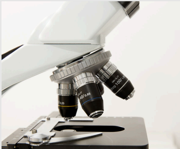
Objectifs d'un microscope avec différents grossissements
