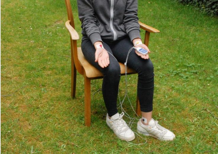
Korrekt angelegte Elektroden
