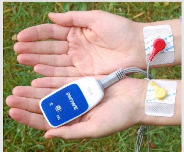
Korrekt angeschlossenes Messgerät
