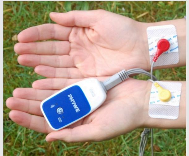
Instrumento de medición correctamente conectado
