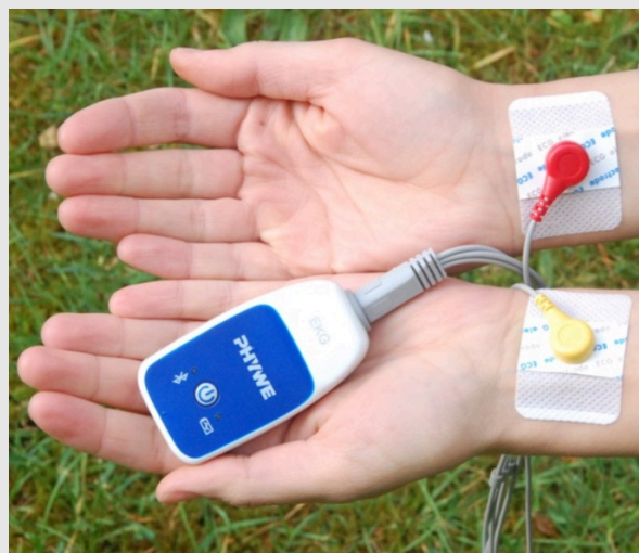
Правильно подключенный измерительный прибор
