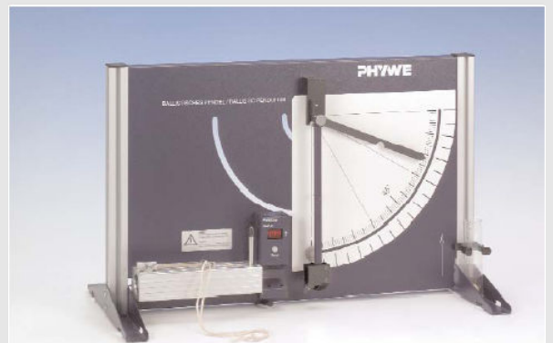
Рис 3: Експериментальна установка з додатковим обладнанням для прямого вимірювання початкової швидкості кульки.
