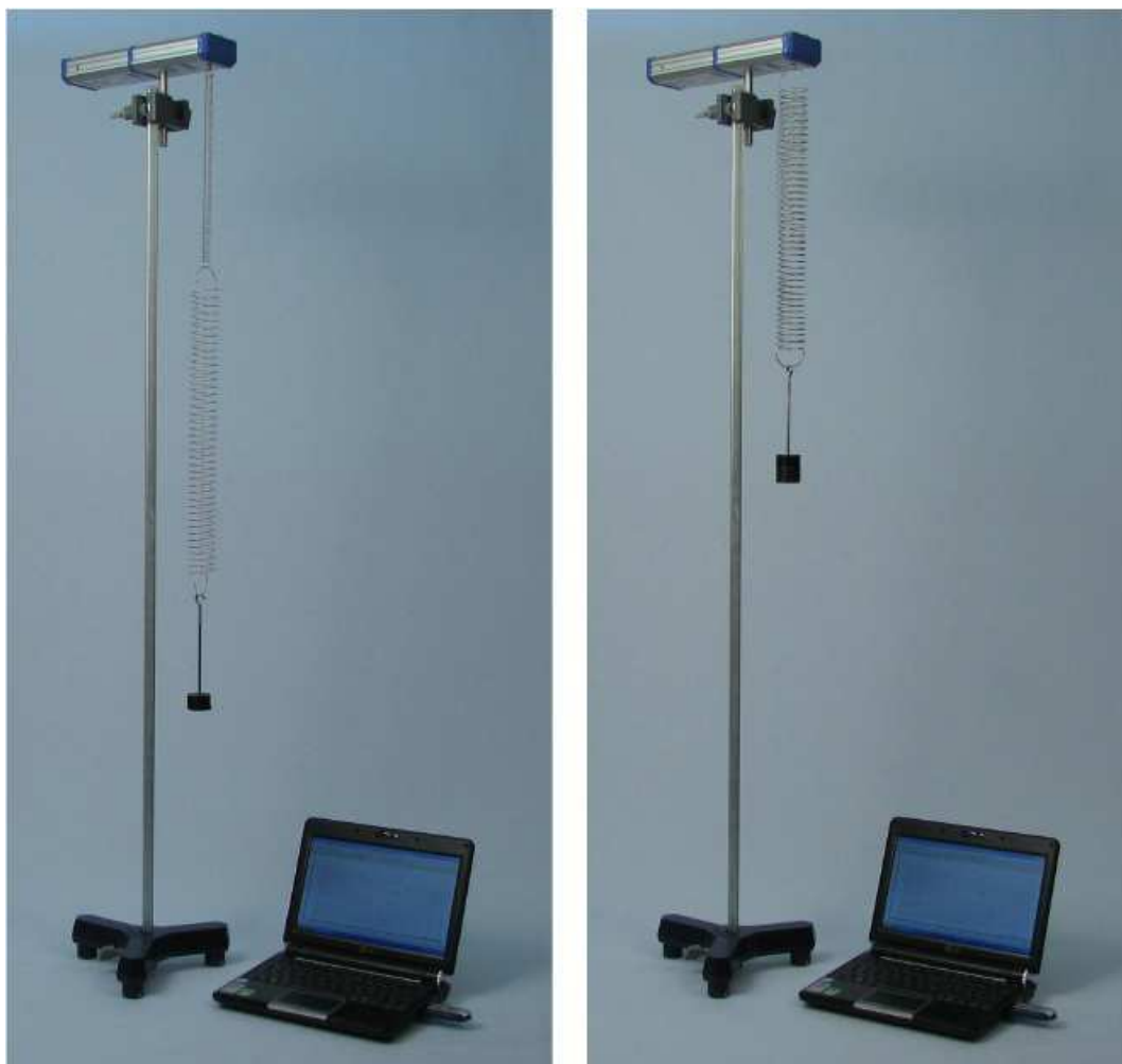
Abb.. 1: Versuchsaufbau, Federn in Reihe und parallel verbunden
