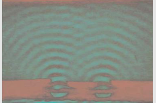
Fig.26: Interferencias en un doble-hendidura. Las ondas circulares emanan de ambas rendijas y forman una característica patrón de interferencia detrás de la hendidura
