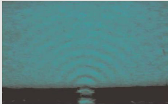
Рис.25: Дифракция на узкой щели. Можно четко распознать исходящие из щели круговые волны, а также их распространение в геометрическую область тени барьера.
