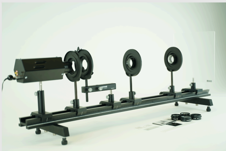
Экспериментальная установка (микроскоп)
