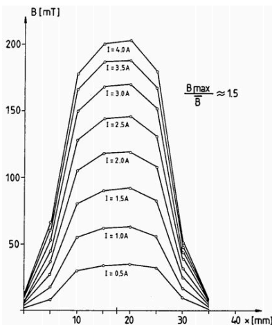
Distribución de la densidad de flujo entre las piezas polares para diferentes corrientes de bobina.
