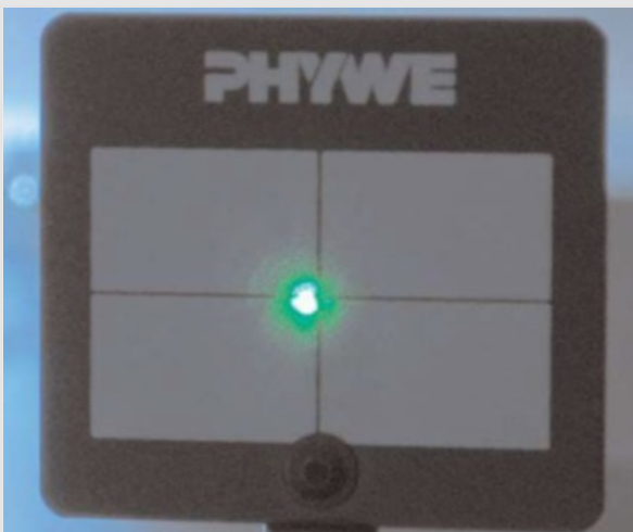
Buena alineación del tubo láser
