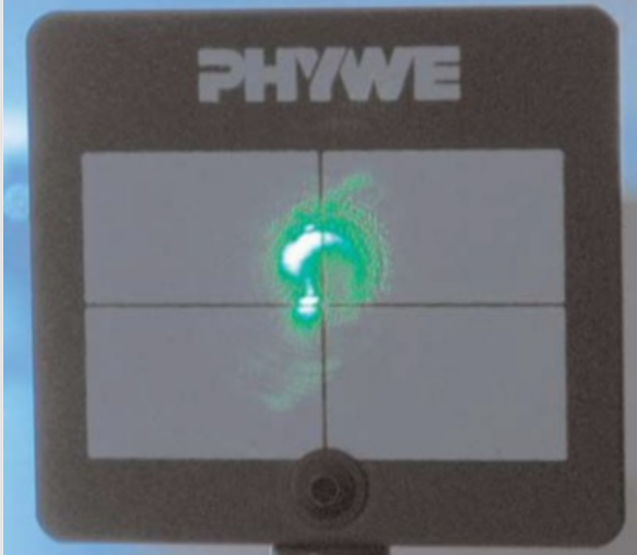
Mala alineación del tubo láser
