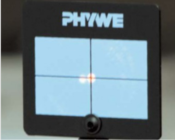
Rayo centrado en el diafragma derecho con rayo fantasma visible a la izquierda del
