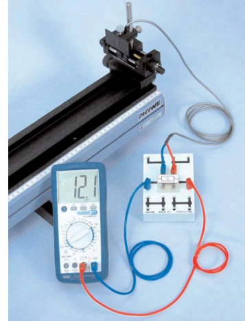
Dispositivo deslizante con elemento fotográfico.
