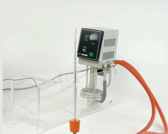
Fig.3. Dispositif expérimental pour la mesure de la dilatation thermique
