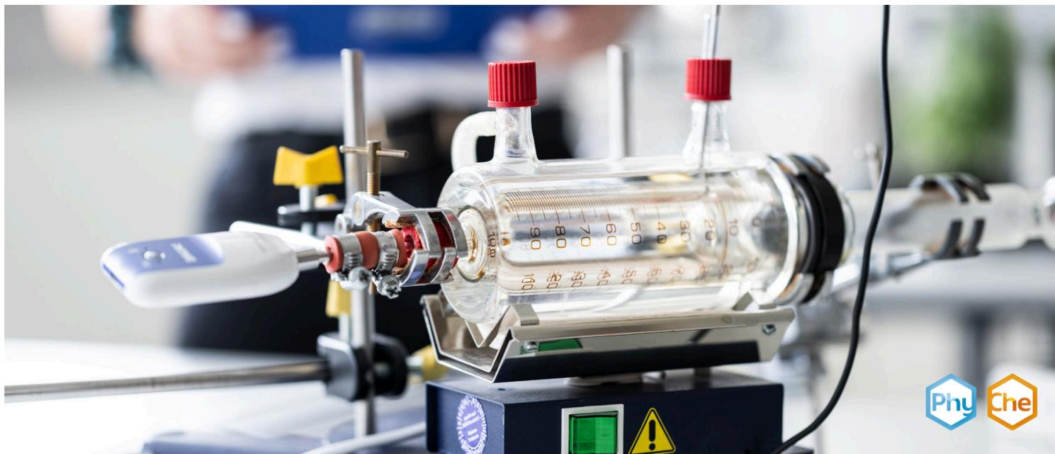
In diesem Experiment wird die Gültigkeit der allgemeinen Gasgesetze bestätigt. Dabei werden jeweils gleiche Luftvolumina unter Veränderung der äußeren Einflüsse wie Druck oder Temperatur untersucht
