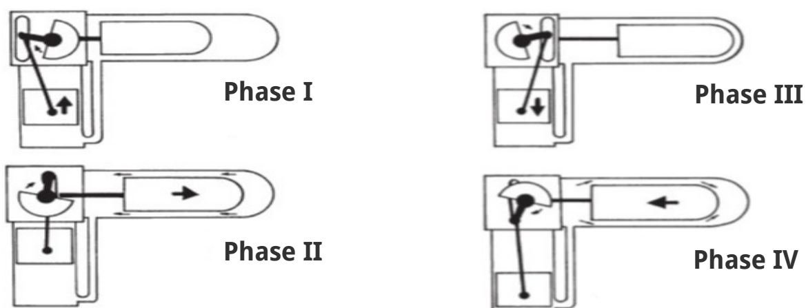
Funktionsweise des Stirlingmotors; Phase I, II, III, IV
