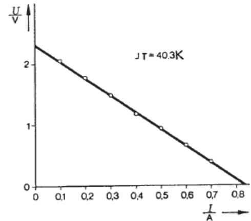
Fig. 5 : Tension aux bornes en fonction de l'intensité du courant pour une différence de température constante.
