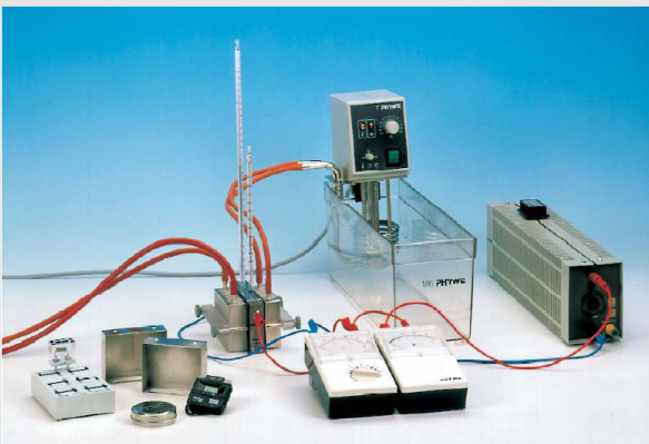
Fig. 1: Montaje experimental para medir la tensión en vacío y la corriente de cortocircuito en función de la diferencia de temperatura.
