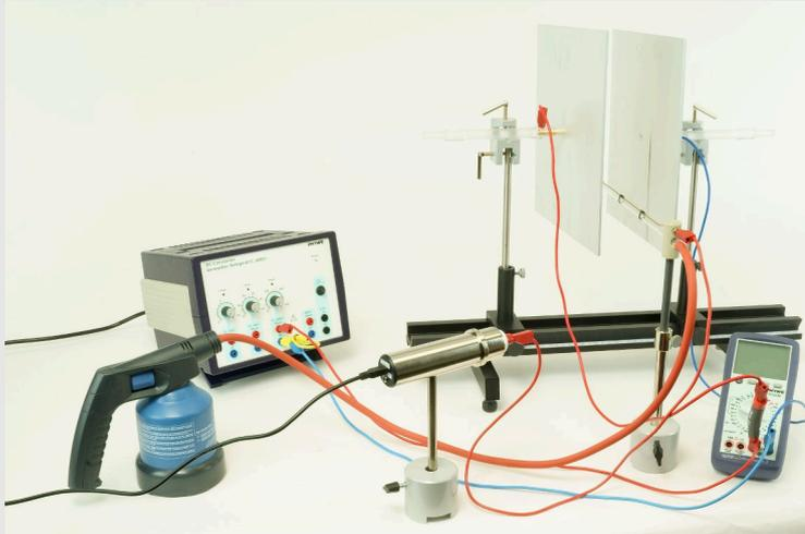
Mesure du potentiel en fonction de l'emplacement entre les plaques
