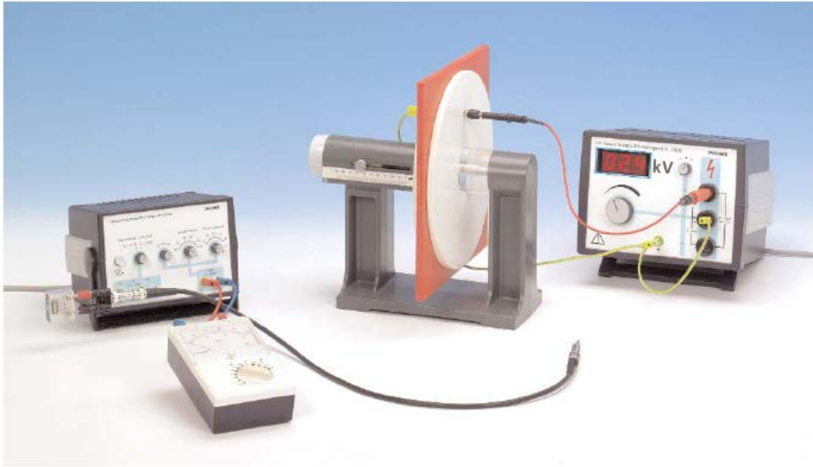
Şekil 1. Ölçüm ayarı: Farklı malzemelerin dielektrik sabiti
