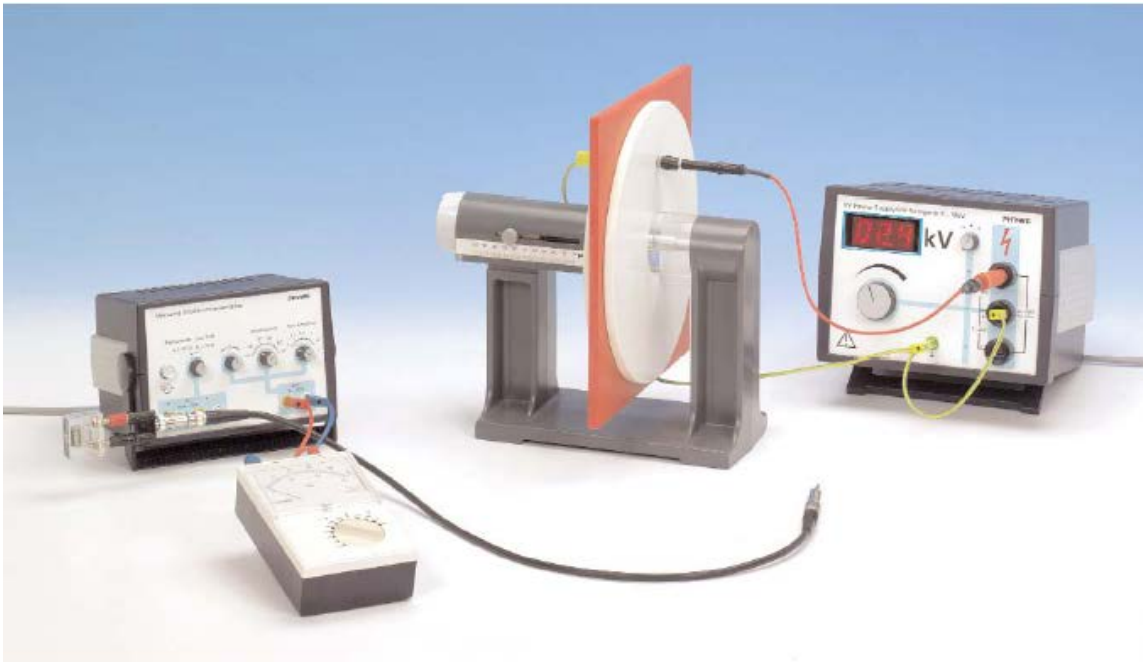
Şekil 1: Ölçüm kurulumu: Farklı materyallerin elektrik geçirmezlik sabiti
