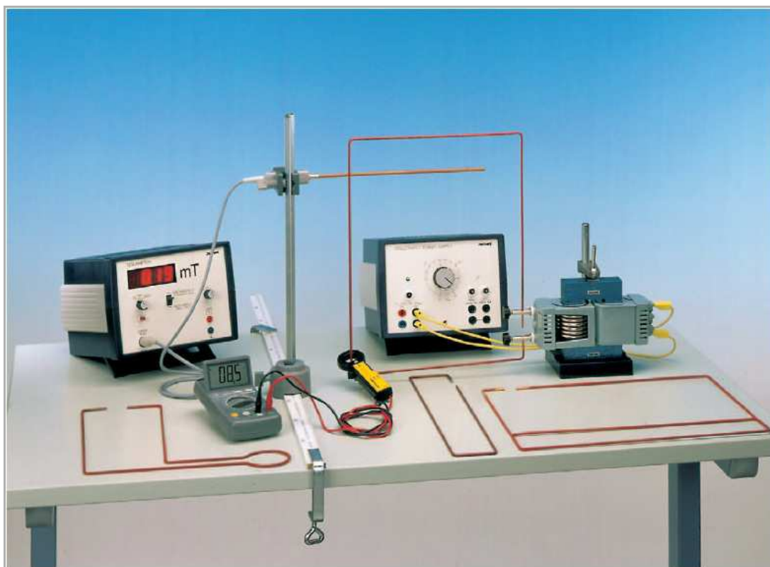
Abb. 1: Experimenteller Aufbau zur Bestimmung des Magnetfeldes im Außenraum gerader Leiter.
