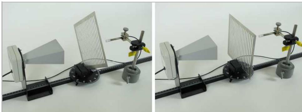
Abb. 6: Transmissionsmessung unter verschiedenen Winkeln
