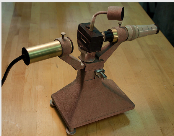
Аппарат Милликена для экспериментов с каплей масла
