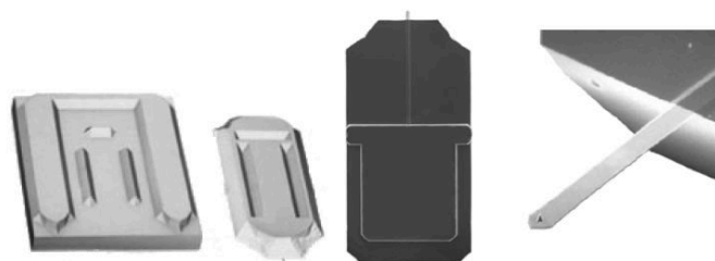
Figura 14: (Izquierda) Sistema de alineación. (Centro) Chip en voladizo visto desde arriba. (Derecha) Voladizo de 450 µm de ancho con punta integrada.
