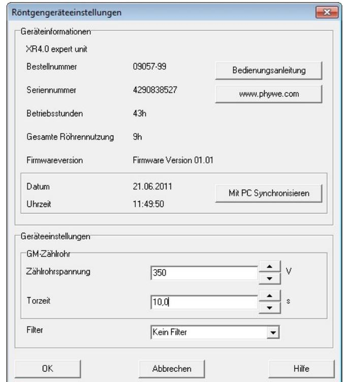
Abb. 4: Einstellung der GM-Spannung
