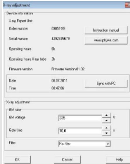
Fig. 5: Ajustes de la tensión GM
