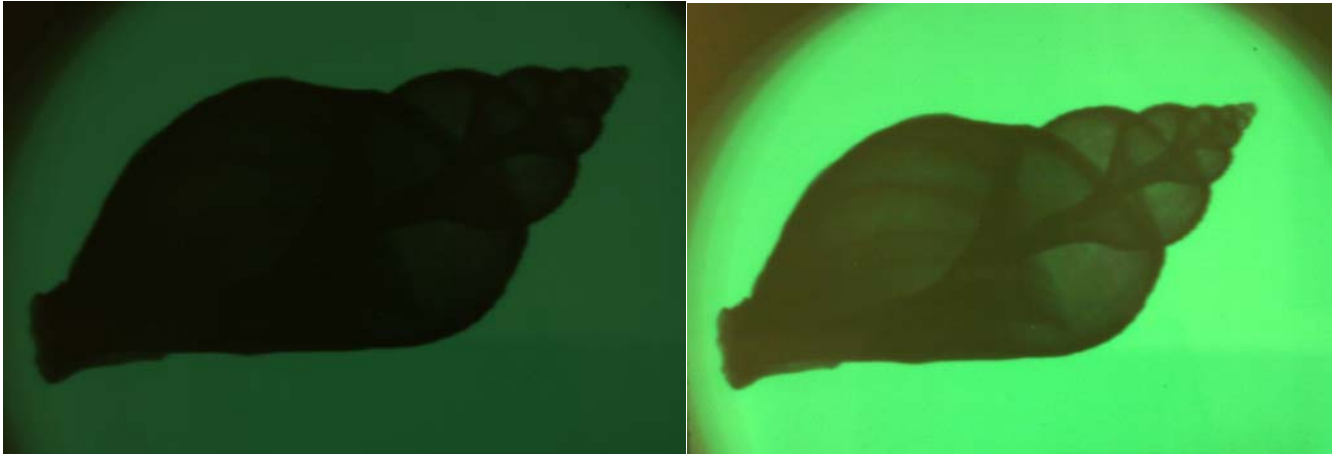
Abb 4: Wellhornschnecke bei unterschiedlicher Anodenspannung.
