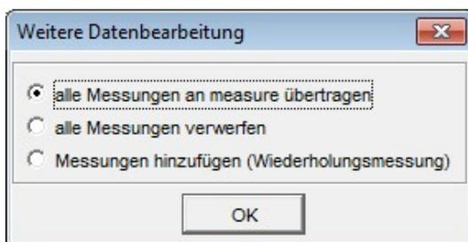
Markieren Sie den ersten Punkt und bestätigen Sie mit OK. Die Messwerte werden nun direkt an die Software measure übertragen.
