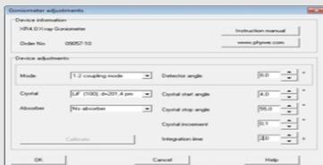
Fig. 6: Ajustes del goniómetro (cristal de LiF)
