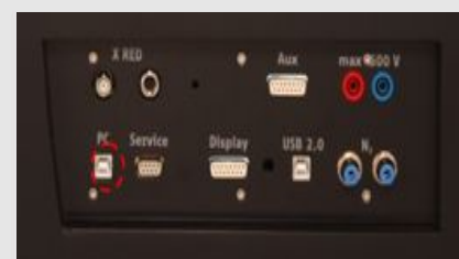
Fig. 4: Conexión del ordenador
