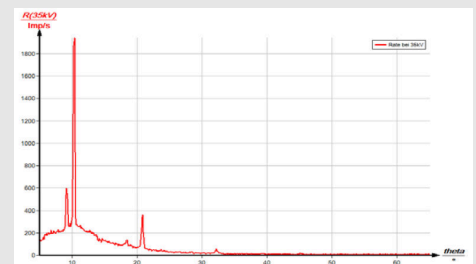
Fig. 7c: Espectro de rayos X del molibdeno (Z = 42)
