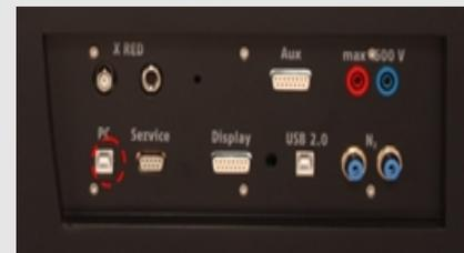
Рис. 5: Подключение компьютера
