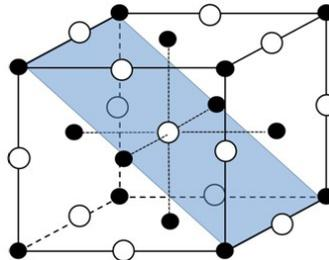
Рис. 2б: Кристалл NaCl с втянутой (110) плоскостью решетки
