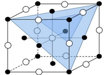
Рис. 2с: Кристалл NaCl с втянутыми плоскостями решетки (111) и (222).
