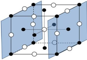
Рис. 2а: Кристалл NaCl с втянутыми (100) плоскостями решетки
