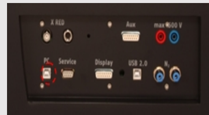
Fig. 5: Conexión del ordenador
