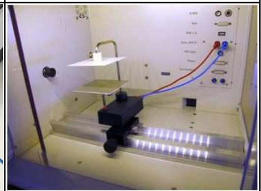
Abb. 5: Aufbau und Verkabelung des Plattenkondensators im Experimentierraum
