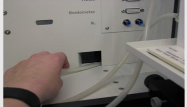
Fig. 3: Tubos colocados en el canal de trabajo
